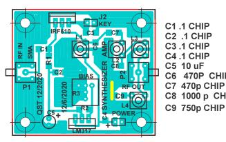
C1.1 CHIP **C2** .1 CHIP **C3** .1 CHIP **C4.1 CHIP** C5 10 uF C6 470P CHIP C7 470p CHIP C8 1000 p CHIP
